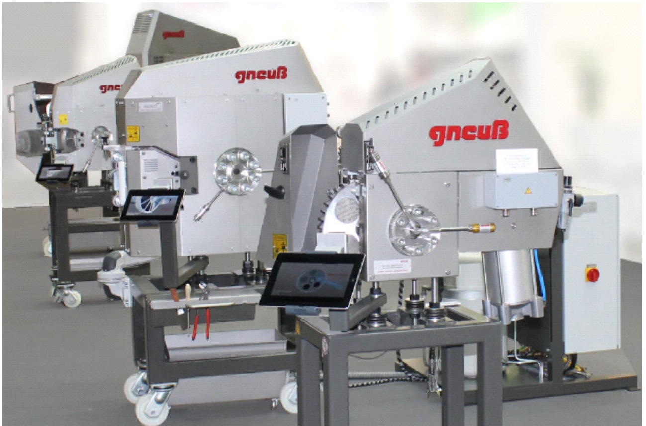
Fig.2: Sistemas de filtración continua de Gneuss a proceso y presión constantes
